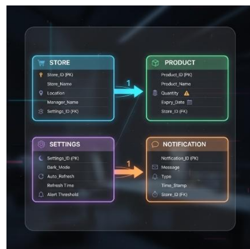
Fig. 3: ER Diagram (Conceptual Data Model)
